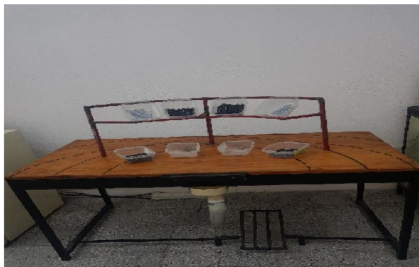
Fig.3. “Ubicación de las cajas 1 y 2, sobre la mesa”. Descripción del proceso manual de ensamble, paso a paso.
